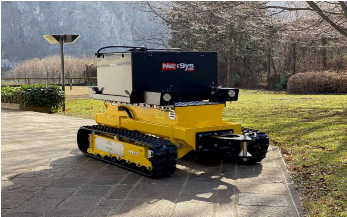
Figure 1 – DCT450MT avec chenilles inclinables et bloc batteries externe
